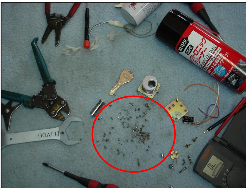
キースイッチを分解して、ピン抜き作業中。
